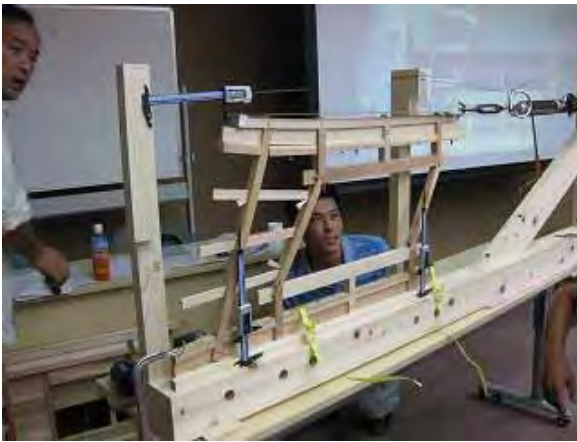
試験体 No. 6 の破壊性状
