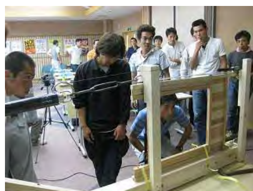
改良した実験装置（右のバネ計りで引き寄せ、デジタル式ノギスを3カ所に取り付け）
